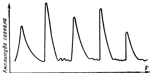
Рис. 57. Осциллограмма сигналов, отраженных от следов метеоров.
